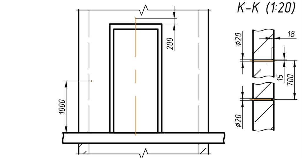
Вариант 2. Совмещенная установка кнопки вызова лифта и кнопки для режима ППП при установке переговорной связи УПСЛ-М ООО "Текон Автоматика" и Одъ 7.2 ООО "ЛКДС"
