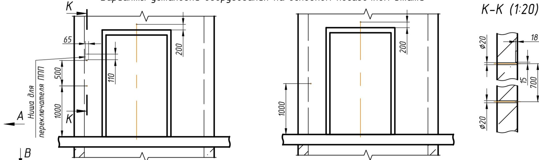
Вариант 1. Раздельная установка кнопки вызова лифта и кнопки для режима ППП при установке переговорной связи СРЛС ООО "Нейрон"
